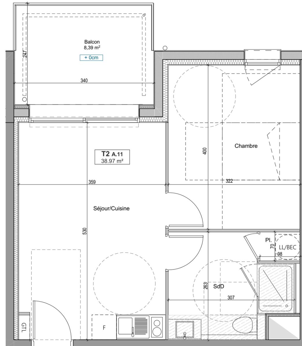
LEGENDE : PF : Porte-Fenêtre / F : Fenêtre / VR : Volet roulant / etel : Tableau électrique / Pl. Placard / TRI : Emplacement tri sélectif / R : Emplacement réfrigérateur / LL : Emplacement lave-linge / LV : Emplacement lave-vaisselle / Soffite, Faux-plafond :
